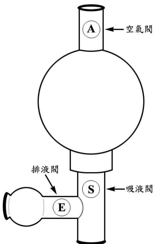
(1)上圖示為一舊式的安全吸球，此次實驗不適用實驗室所提供的新式安全吸球，而為了能夠順利且無阻礙的吸取飽和溶液，吸球傳統的標準使用方法在此將稍作改變。
